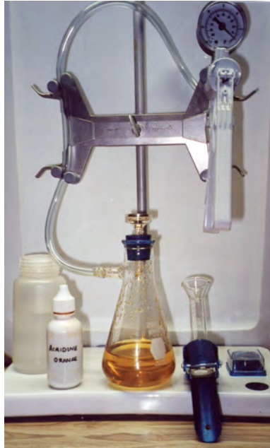
Membrane Filtration Apparatus
